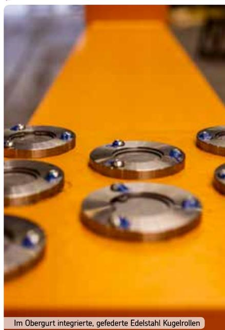
Im Obergurt integrierte, gefederte Edelstahl Kugelrollen
