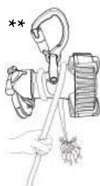
BEI MAX. LAST: Seilgehäuse anderthalb Mal umwickeln
