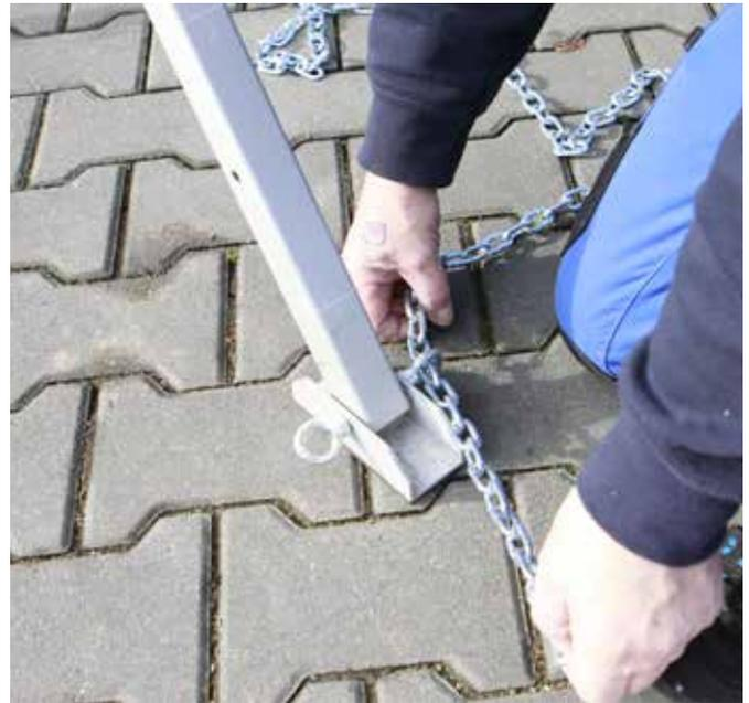
Abb. 15 + 16: Sicherungskette durch die ÖÙe am 1. Fuß einfädeln und bis zum 2. (nächstgelegenen) Fuß weiter durchziehen.
