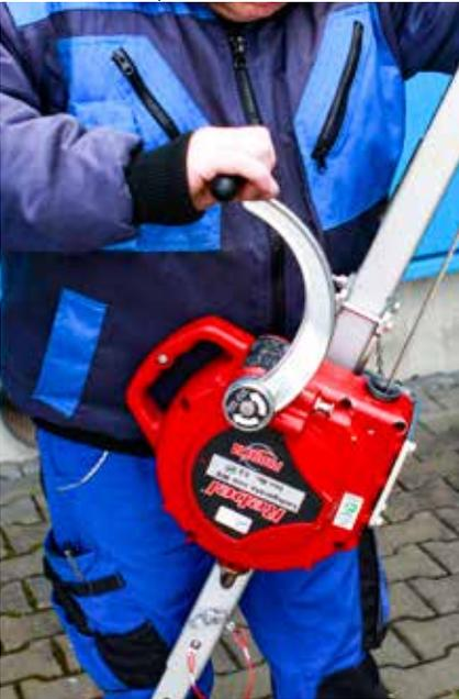
Abb. 49 + 50 : Zum Heben und Senken die Kurbel bedienen!
