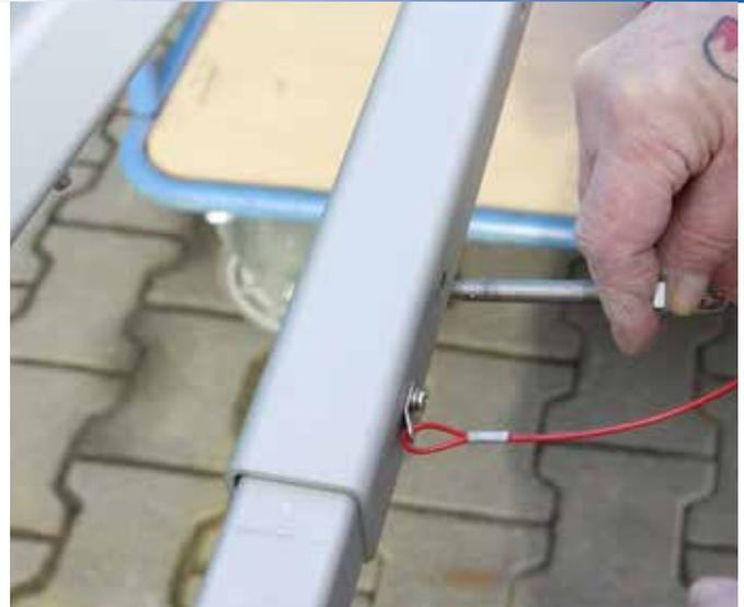
Abb. 1 + 2: START: Steckbolzen zur Verlängerung der Dreibaum-FüÙe durch Drücken entriegeln und herausziehen.
