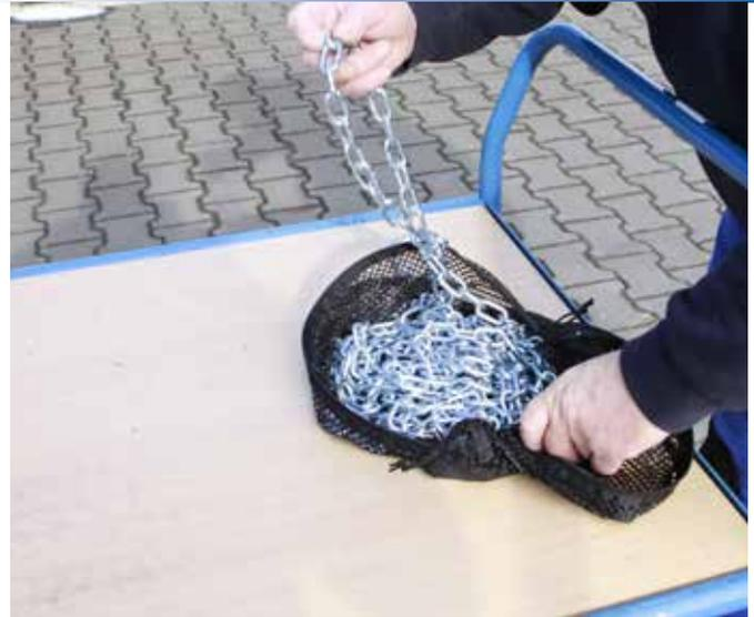
Abb. 14: Sicherungskette aus dem Transportnetz nehmen.
