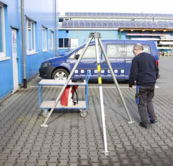
Abb. 13: Kontrollieren, dass alle drei FüÙe eingerastet sind.
