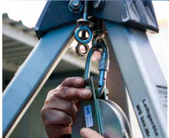
Abb. 37 + 38: ...dem mitgelieferten Steckbolzen wie abgebildet am Karabiner anbringen.
