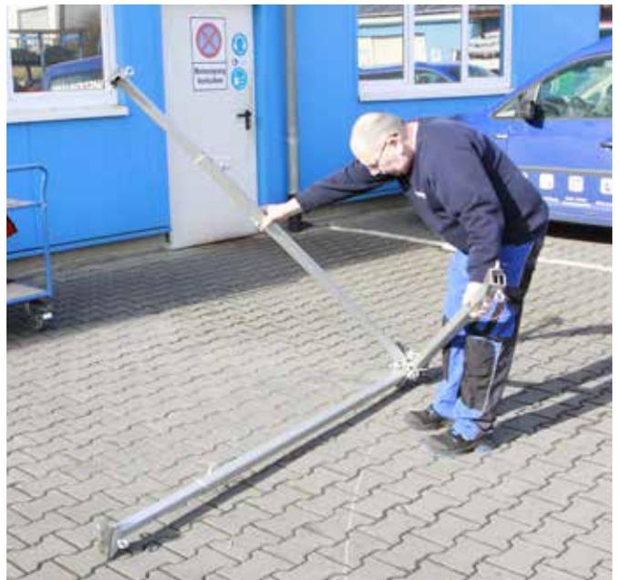
Abb. 58: Den Sicherungsstift wieder einsetzen.
