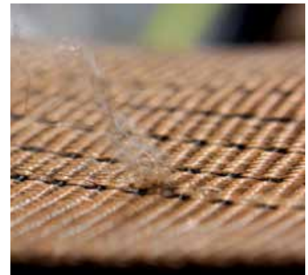
Beispiel für ein Abergereifes Chemiefaser-Anschlagmittel
