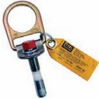
**D-Ring-Anschlagpunkt für Beton**, mit Befestigungsmaterial, um 360° drehbar, zugelassen bis 22 kN, Tragkraft: 140 kg, Gewicht: 0,5 kg, gemäß EN 795 A
