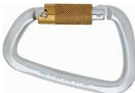
**Karabiner mit Triplelock-Verschluss**, aus Stahl, Bruchlast 50 kN, Schnapperöffnung 24 mm, gemäß EN 362
