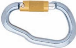
**HMS-Triplelock-Karabiner**, aus Aluminium, mit Dreifachsicherung, Farbe titan, Bruchlast 22 kN, Schnapperöffnung 24 mm, gemäß EN 362
