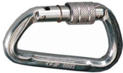
**Karabinerhaken mit Schraubverschluss**, aus Aluminium, Bruchlast 24 kN, Schnapperöffnung 19 mm, gemäß EN 362
