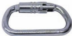
**Karabiner mit Twistlock-Verschluss**, aus Stahl, Bruchlast 25 kN, Schnapperöffnung 18 mm, gemäß EN 362
