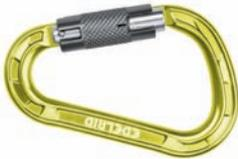
**HMS-Twistlock-Karabiner**, aus Aluminium, Farbe oasis, mit Zweifach-sicherung, Bruchlast 25 kN, Schnapperöffnung 24 mm, gemäß EN 362
