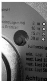
Abb. 2: Fallindikator an den Geräten im Ausgangszustand Sichtbare Mutter muss grün sein! Ist die grüne Mutter nicht mehr oder eine rote Mutter sichtbar, wurde das Gerät ausgelöst
