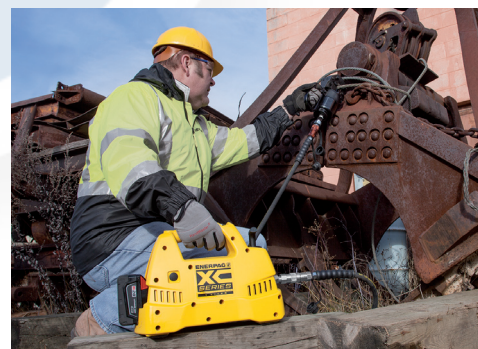
Akkupumpe im Einsatz mit einem Schneidgerät
