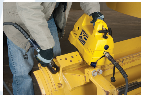
Akkupumpe im Einsatz mit einem Mutternsprenger
