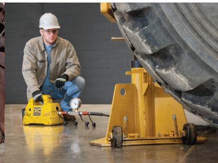
Einsatz mit einem Maschinenheber
