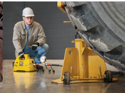
Einsatz mit einem Maschinenheber
