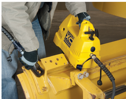
Einsatz mit einem Mutternsprenger
