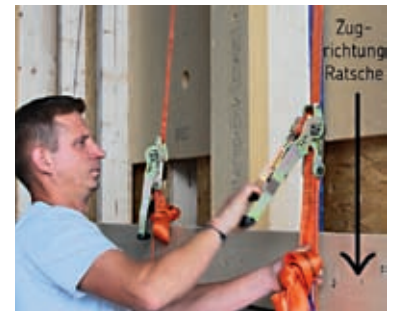
Leichtes Zurren mit der Langhebelzugratsche
