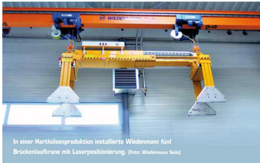
In einer Harthülsenproduktion installierte Wiedenmann fünf
