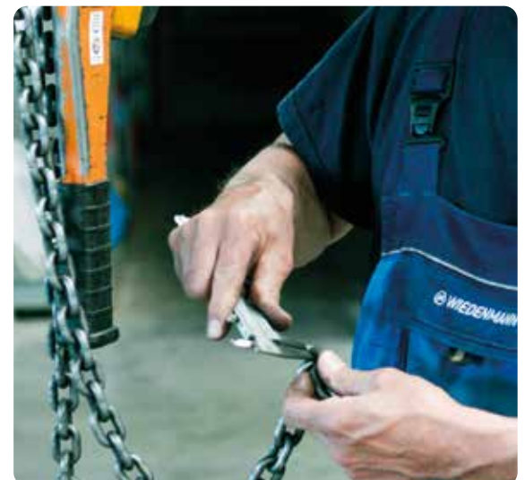
Kettenprüfung durch einen Sachkundigen
